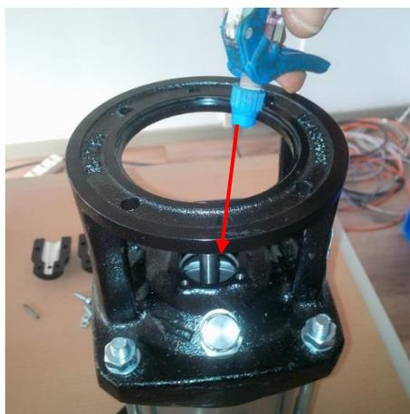
**B9. Platzieren Sie die Cartridge-Gleitringdichtung (K111-6) über die Welle auf den Motorträger so, dass die Bohrungen der Gleitringdichtung auf den Bohrungen des Motorträgers liegen.**
