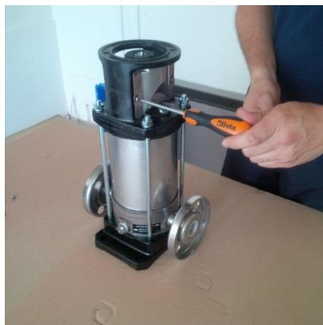
**B3. Entfernen Sie die 4 Schrauben (120-6), die Unterlegscheiben (135-6) und die Muttern (128-6) der Kupplung. Entfernen Sie die Kupplung (140). Entfernen Sie den Zylinderstift (131-1).**
