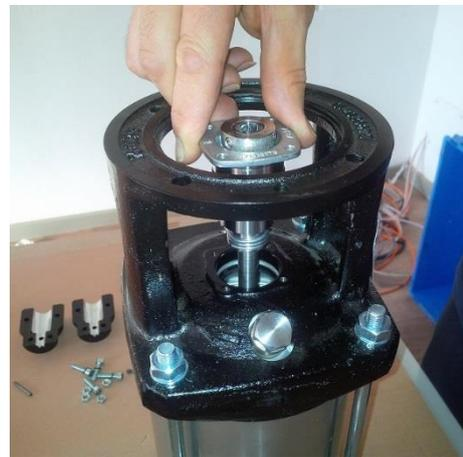
**B10. Fixieren Sie die 4 Schrauben des Dichtungsträgers (120-3) überkreuzt.**
