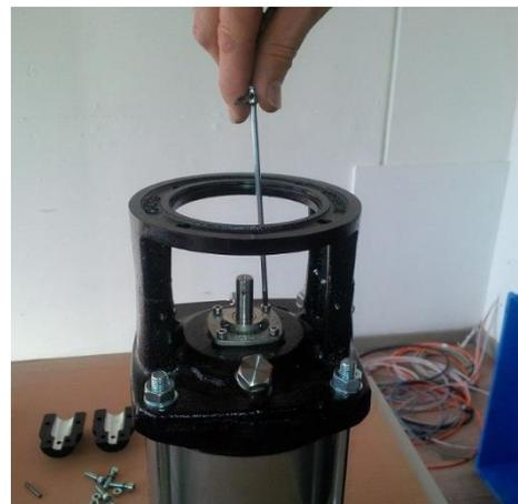
**B5. Heben Sie den Dichtungsträger (111-3) soweit an, bis Sie einen Spalt zwischen dem Dichtungsträger und dem Dichtungssitz sehen.**
