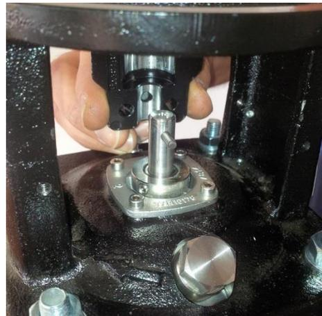
**B13. Fixieren Sie die 4 Schrauben (120-6), die Unterlegscheiben (135-6) und die Muttern (128-6) der Kupplung überkreuzt.**
