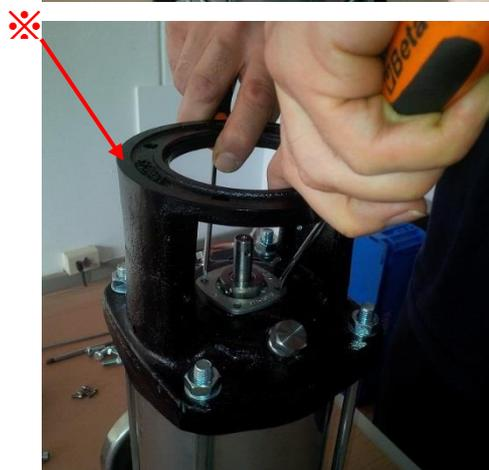
**B6. Entfernen Sie mit der Hand die Cartridge-Gleitringdichtung (K111-6).**
