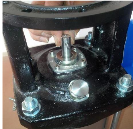
**B12. Montieren Sie die Kupplung (120-6) hierfür fügen Sie den Zylinderstift in die dafür vorgesehene Bohrung der Kupplung.**
