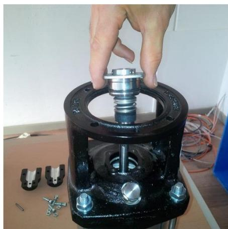
**B7. Nehmen Sie sich das neue Cartridge-Gleitringdichtungs-Kit (K111-6).**
