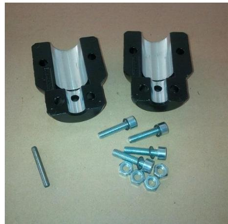
**B4. Entfernen Sie die 4 Schrauben der Cartridge-Gleitringdichtung (120-3).**
