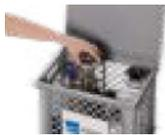
Den Rohrnippel inklusive der C-Kupplung in den Druckstutzen einschrauben.
