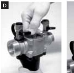
Verwijder de ontlastklep cartridge (8) met een M10 bout.
