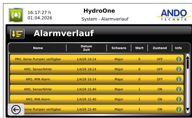
Abbildung 7.3: System - Meldungs- und Alarmverlauf
